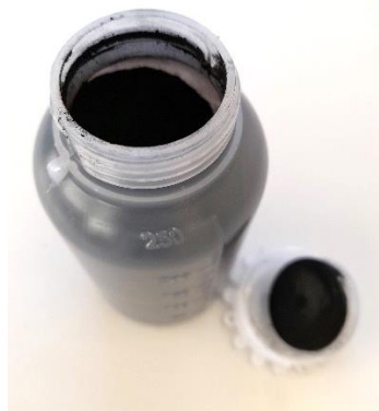
Figura 10.- Aspecto del hydrochar refinado en el que se empezaron los estudios a la espera del procedente de los residuos específicos del proyecto.
