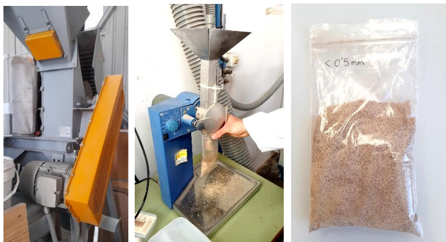
Figura 2.-Los dos triturados posteriores realizados en AIDIMME y aspecto final de la muestra (dcha.).
