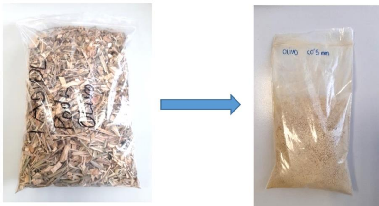
Figura 5.-Muestra inicial procedente de la poda (izqda.) y aspecto final de la muestra después del triturado (dcha.).
