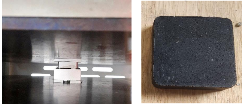
Figura 14.- Prensado de hydrochar refinado con fenol-formaldehído con el molde pequeño
